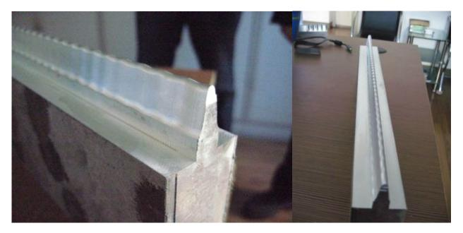
在上个月清华大学 CPHS 加速器团队和美国原洛斯阿莫斯国家实验室(Los Alamos)专家们完成了 射频四极直线加速器 RFQ 的物理设计后,上海克林公司加工出 RFQ 主极头的铝模样机以验证机械 加工精度(见上图)。接下来将加工铜制极头样机,CPHS 加速器团队、前洛斯阿莫斯专家及上海克 林的技术人员正密切合作以实现新的设计理念。
