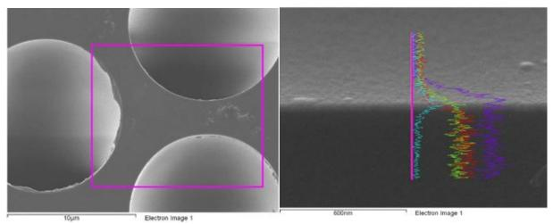
清华大学工程物理系核技术研究所杨祎罡副教授带领的小组完成了中子探测转换器微通道板(MCP)的镀膜研制。背散射电子扫描的显微分析结果表明,在 MCP 微孔镀材料 Gd<sub>2</sub>O<sub>3</sub> 膜是成功的,接下来 将用 <sup>10</sup>B 进行镀膜研制。这一系列研究对于寻找可能替代氦-3 管的中子探测器的国际协作有十分重 要的意义。
